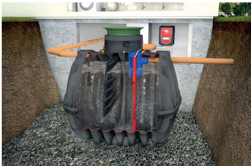
La microstation easyOne de Graf repose sur le principe SBR. Le traitement se fait dans une seule cuve et un seul compartiment. La suppression des étapes de transferts pour l'alimentation en eaux usées et le retour des boues réduit la consommation d'énergie.
