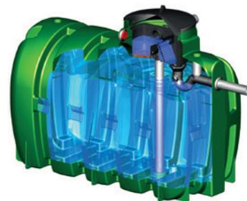
La cuve en polyéthylène 30SPK de Sebico permet de stocker les eaux de pluie jusqu'à 3.000 l. Ces eaux peuvent ensuite être utilisées à des fins domestiques (arrosage, lavage des voitures, alimentation des chasses d'eau des WC, lavage des sols...). La cuve est munie d'un filtre dégrilleur intégré, qui fournit une capacité importante de récupération d'eau et de filtration.
