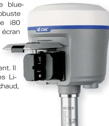
qui offrent une autonomie d'une journée sur le terrain. Grâce au capteur Mems intégré associé au logiciel SurvCE, il compense l'inclinaison de la canne tout en conservant une précision centimétrique, permettant des levés dans des conditions difficiles.
