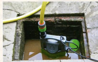
(avec des particules jusqu'à 30 mm), elles peuvent aspirer jusqu'à 3 m du sol et se connectent à un simple tuyau d'arrosage.
