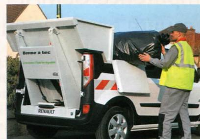
au lithium-ion, placées sous le plancher pour ne pas altérer la capacité de chargement du véhicule. Il atteint 130 km/h et l'autonomie est comprise entre 80 et 125 km selon le type d'utilisation et la saison. La benne mesure 1,70 m de long, 1,45 m de large et 1,17 m entre les passages de roue. La charge utile du véhicule est de 650 kg.
