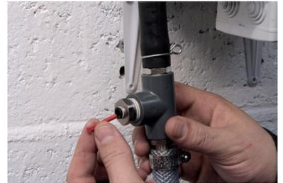
Connecter la réduction Ø 6 mm et le raccord cannelé Ø 4 mm.
