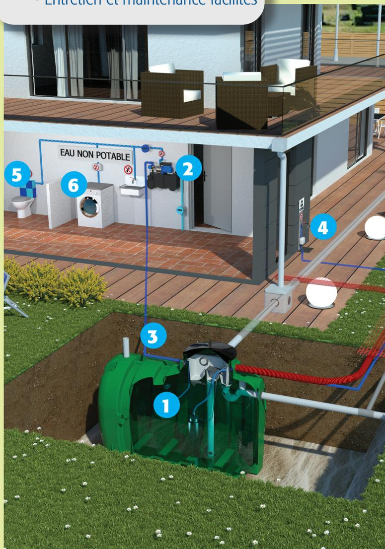
**1. Cuve de stockage Pack'eau** enterrée en polyéthylène ou en béton
