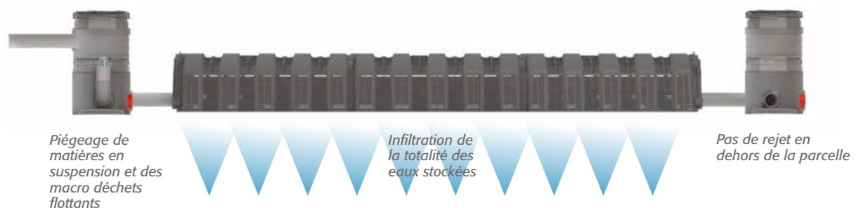
*Note: Cette configuration peut être imposée dans le règlement du PLU pour interdire tout rejet hors de la parcelle afin de limiter son impact sur le réseau d'assainissement, sur le milieu superficiel et les masses d'eau. Elle nécessite une étude de sol pour vérifier que la vidange totale en 24h est possible avec la perméabilité mesurée.*
