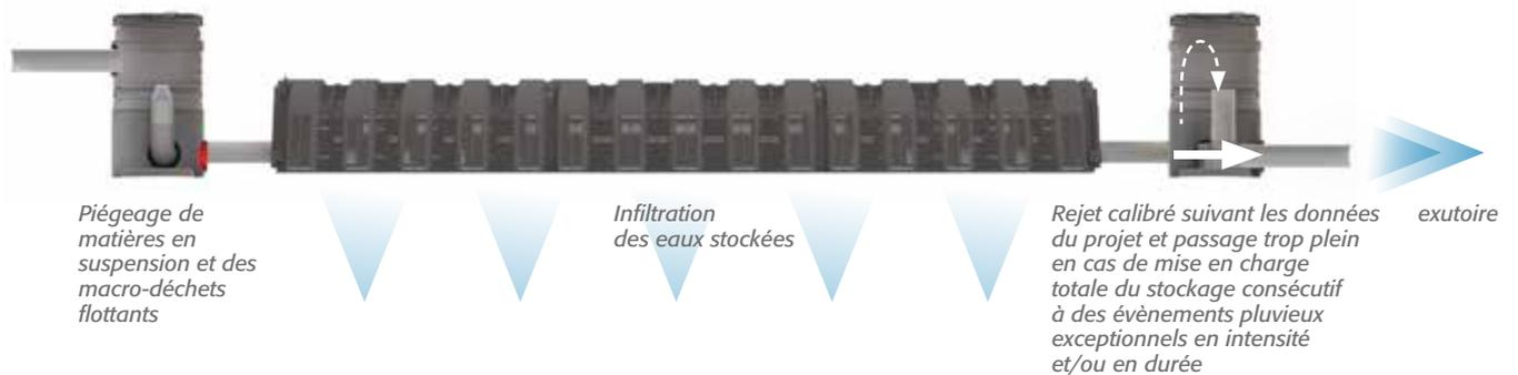
*Note: Cette configuration imposant un volume de stockage temporaire avec évacuation à débit régulé est très souvent demandée. Notre solution limite le volume total rejeté hors de la parcelle grâce à l'infiltration dans le sol.*
