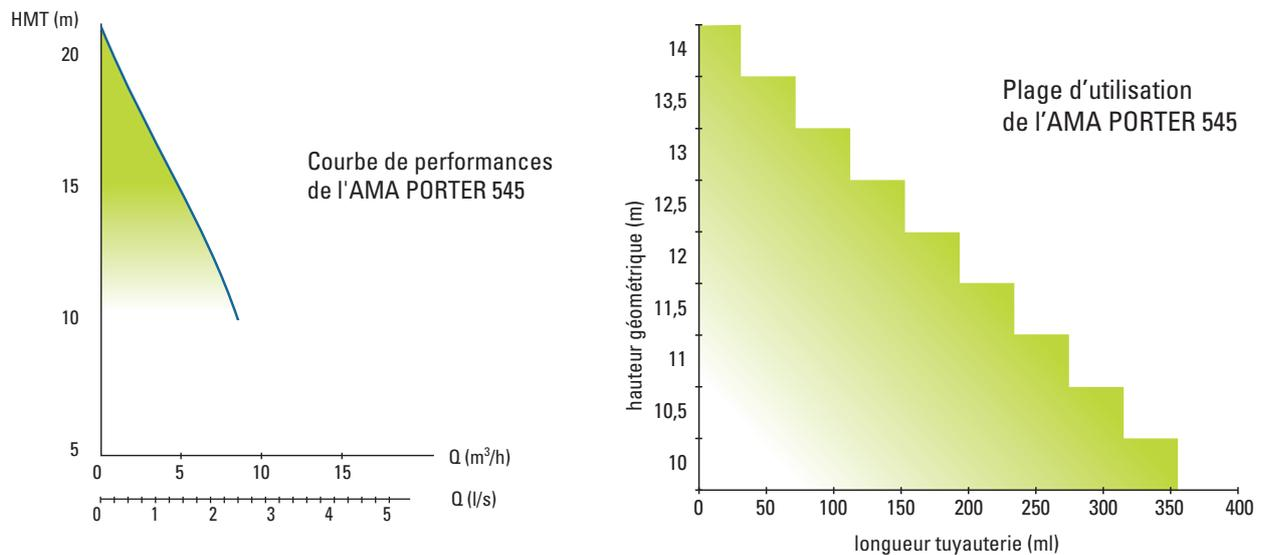
Nota: HMT = Hauteur géométrique + pertes de charge de la conduite et ses équipements (vanne, clapet, coudes...)
