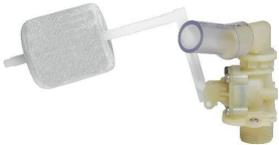
Robinet à flotteur                       | Vérifier que le flotteur s'ouvre et se ferme correctement (étanchéité) et a une mobilité absolue                                                               | tous les 6 mois (en fonction de la teneur locale en calcaire de l'eau potable) | Remplacer le robinet à flotteur (Fiche d'entretien du robinet à flotteur disponible en annexe1, p18) | VF13M4/ & DC13T4/P |
