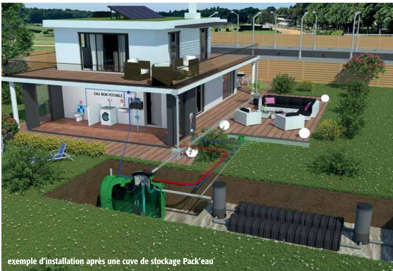
exemple d'installation après une cuve de stockage Pack'eau
