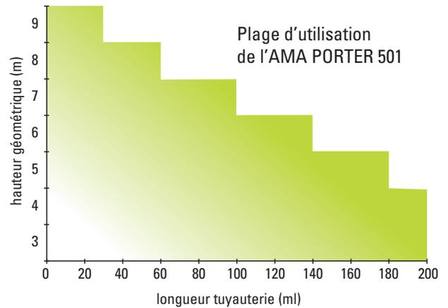
Nota : HMT = Hauteur géométrique + pertes de charge de la conduite et ses équipements (vanne, clapet, coudes...)
